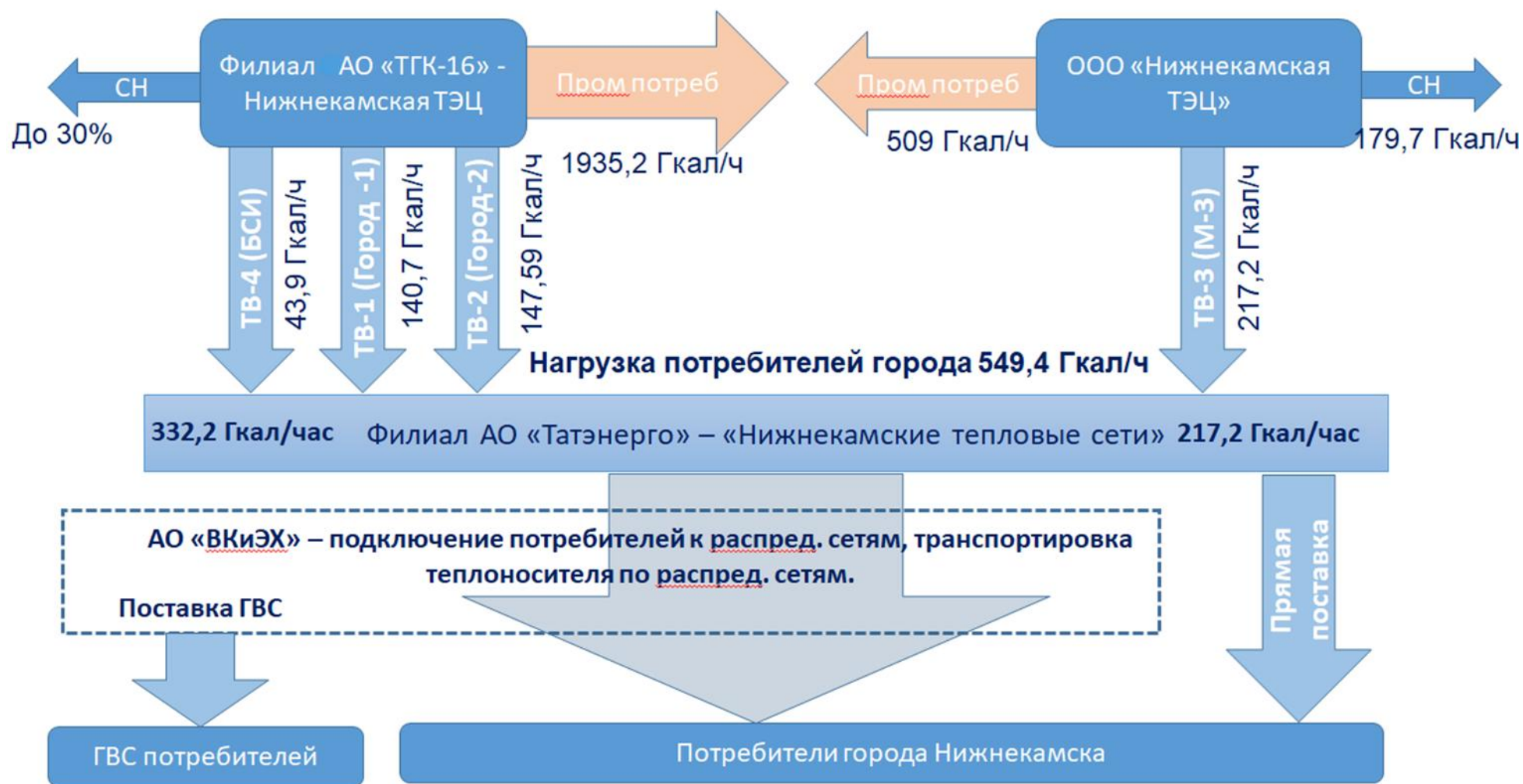
Рис. 1.4. Функциональная структура системы централизованного теплоснабжения города Нижнекамска
